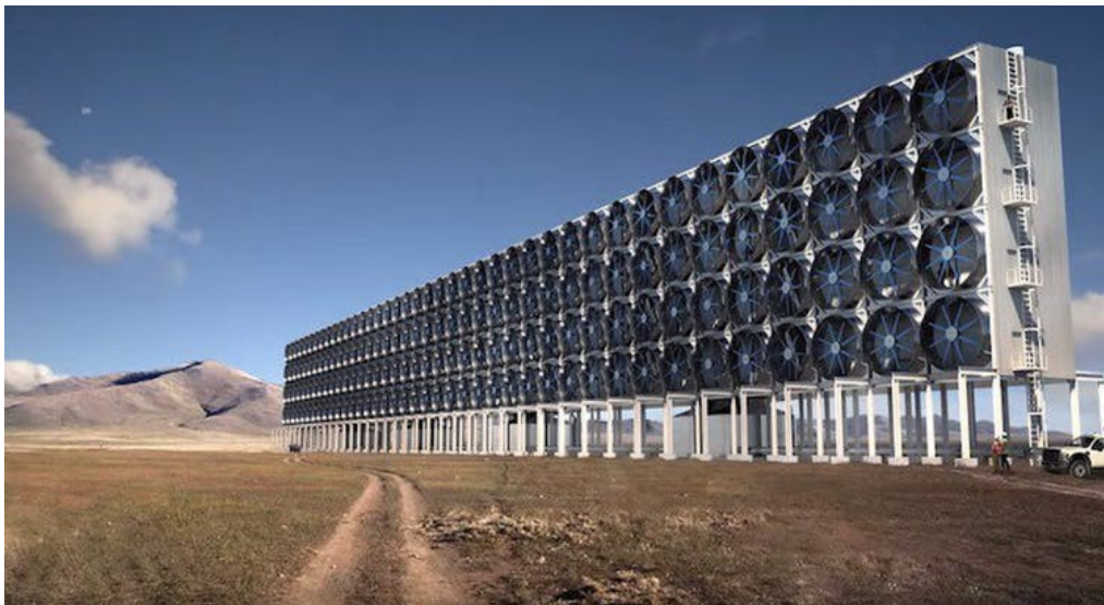
Prototype mis au point par la société canadienne Carbon Engineering pour aspirer le gaz carbonique en vue de le transformer en combustible. Carbon Engineering
